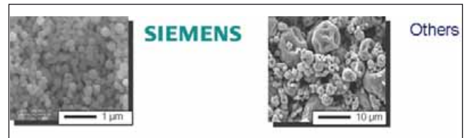
Vergleich zwischen Nanopartikeln und kommerziell erhältlichen Magnetpartikeln
