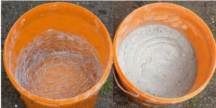
Abbildung 20: Links: Drahtgerüst, Rechts: Aufgefüllt mit Estrich
