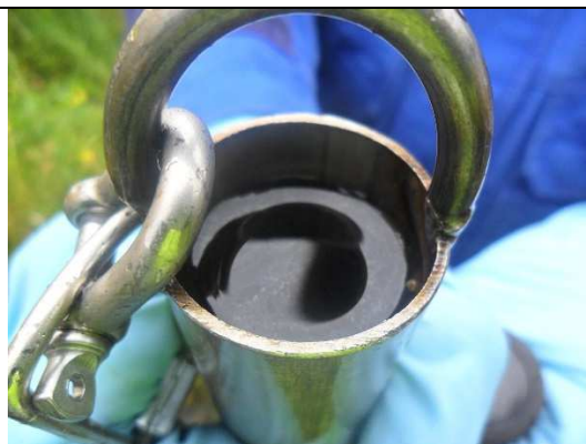
Abbildung 3.2 Probenahme mittels Schöpfzylinder mit aufschwimmendem Phasenfilm in GWM52
