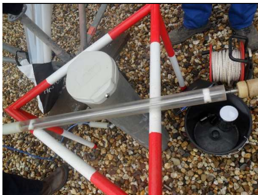
Abbildung 3.1 Probenahme mittels Schichtenheber in GWM89
