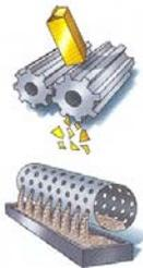
Dazu werden die Kartons zerkleinert und kommen dann in eine 30 Meter lange Trommel, die sich langsam dreht. Unter Zugabe von kaltem Wasser werden die Kartonstücke wie in einer Waschmaschine hin und her geschleudert und weichen langsam auf. Ganz ohne chemische Zusätze! Durch Löcher in der Trommelwand treten die Zellstofffasern aus und werden anschließend in der Papiermaschine verarbeitet. Die Folienreste werden am Ende der Trommel aufgefangen und ebenfalls verwertet.
