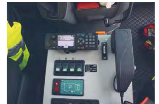
Seit 2019 hat die Feuerwehr Köln sämtliche Einsatzfahrzeuge auf Digitalfunk umgestellt. In den Rettungsdienstfahrzeugen wurden die Digitalfunkgeräte in die Mittelkonsole eingebaut.
